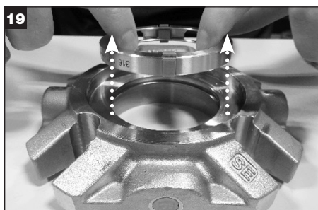
Fjern drivkanalen fra stopbøsningen; fjern kanalclipsen og flowdeflektoren fra kanalen og bortskaf.
